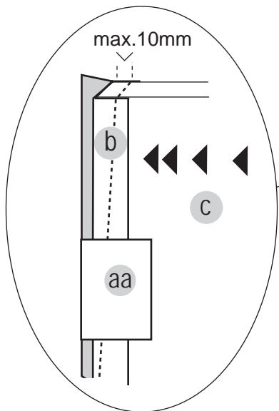
**D** Richten Sie den Flügel **c** senkrecht aus und schieben Sie das Kompensationsprofil **b** an die Wand, so dass die Fuge zwischen Wand und Türe mit der Dichtlippe innen gleichmäßig geschlossen wird. Fixieren Sie dann mit den Scharnieren **aa**.
