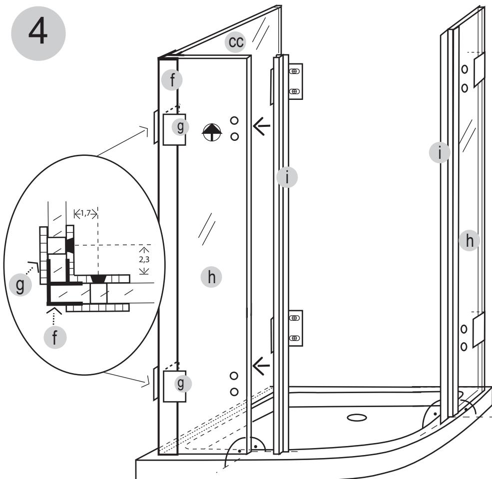
**I** Porre le parete fissa **cc** e il lato fisso **h** in maniera verticale, spingere poi i profili di compensazione **b** con forza verso il muro, cosicché si possano compensare eventuali irregolarità. Fissare poi il tutto con gli attacchi a muro **a**. Nel caso in cui il muro sia esattamente diritto, si può rinunciare al profilo di compensazione **b** siliconando direttamente il lato verticale (distanza muro / vetro min. 2 mm).
