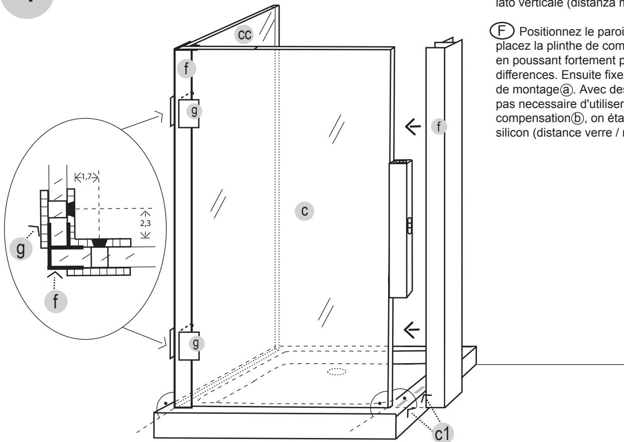
**F** Positionnez le paroi fixe **(cc)** d'aplomb et placez la plinthe de compensation **(b)** sur le mur en poussant fortement pour égaler les différences. Ensuite fixez la plinthe avec les vis de montage **(a)**. Avec des murs droits, il n'est pas nécessaire d'utiliser la plinthe de compensation **(b)**, on étanche avec un joint de silicon (distance verre / mur min. 2 mm).
