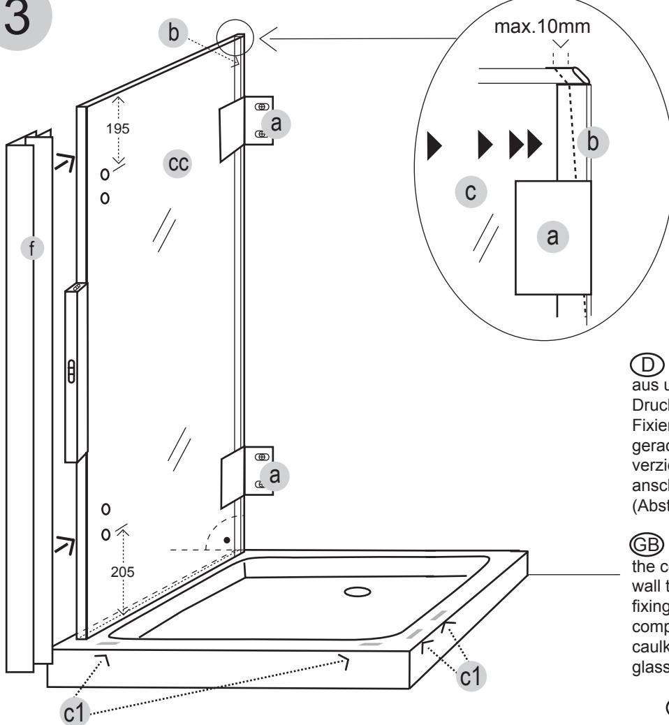
**D** Richten Sie die feste Seitenwand **(cc)** senkrecht aus und schieben Sie das Kompensationsprofil **(b)** mit Druck an die Wand um Schrägen auszugleichen. Fixieren Sie dann mit den Wandbefestigungen **(a)**. Bei gerader Wand kann auf das Kompensationsprofil **(b)** verzichtet werden und dersenkrechte Wandanschluss absilikoniert werden (Abstand Wand / Glas min. 2 mm).
