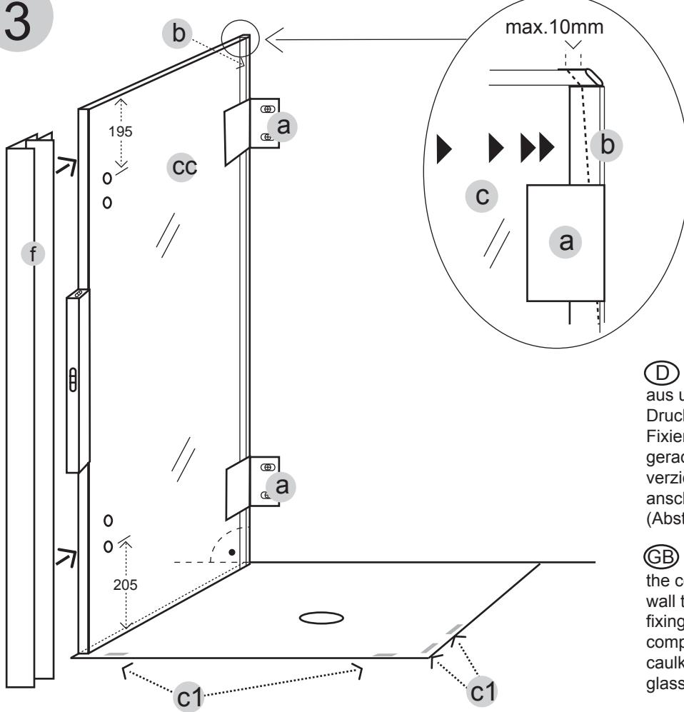
**D** Richten Sie die feste Seitenwand **cc** senkrecht aus und schieben Sie das Kompensationsprofil **b** mit Druck an die Wand um Schrägen auszugleichen. Fixieren Sie dann mit den Wandbefestigungen **a**. Bei gerader Wand kann auf das Kompensationsprofil **b** verzichtet werden und dersenkrechte Wandanschluss absilikoniert werden (Abstand Wand / Glas min. 2 mm).
