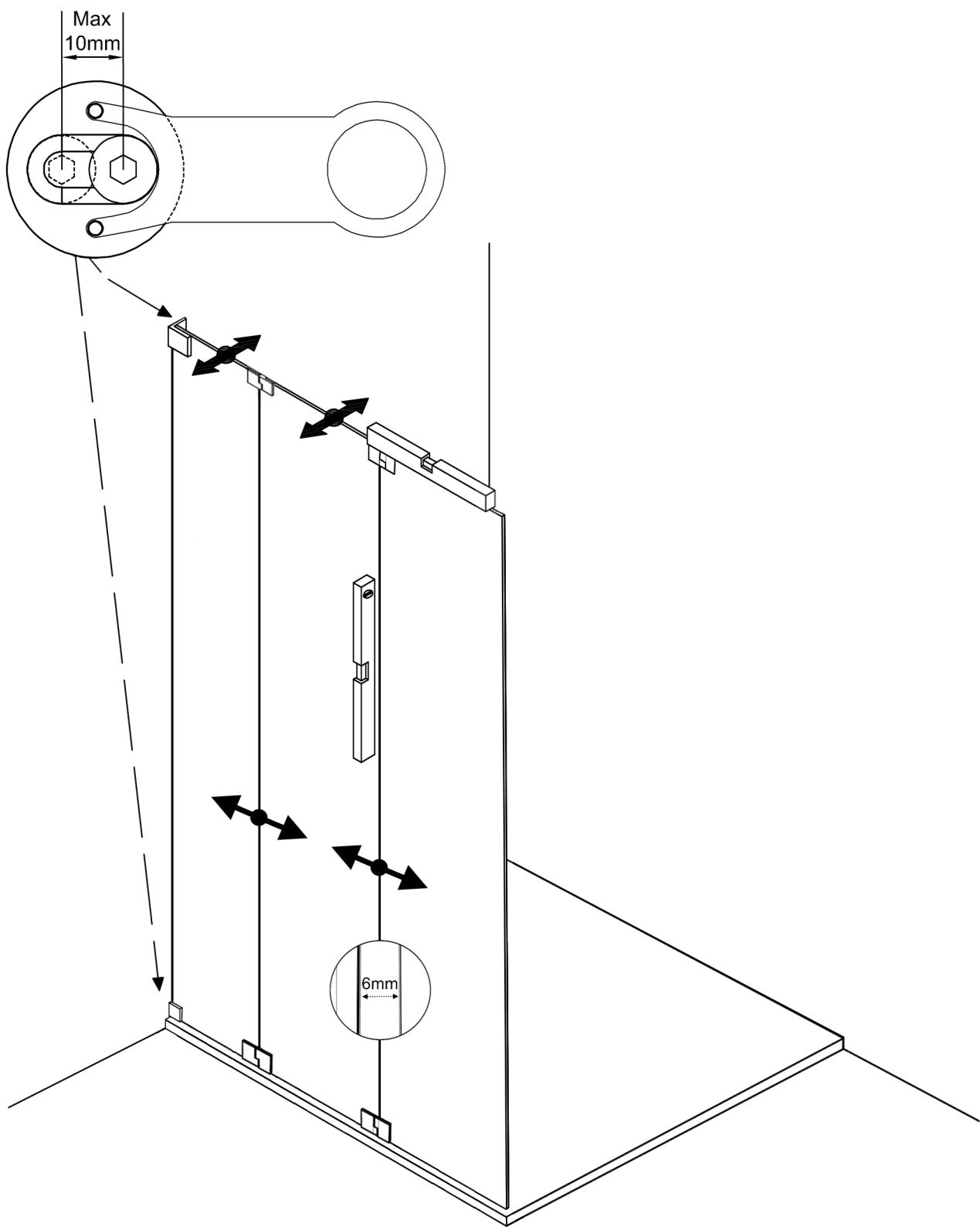
Richten Sie das Glas-Festeil senkrecht aus und fixieren sie die Inbus-Schrauben in den Langlöchern der Glasbefestigungen. Mit dem Montage-Schlüssel können die Glasbefestigungen dabei waagerecht gehalten werden. Schieben Sie dann das Kompensationsprofil (G13 / G13H) auf dem Glas mit Druck an die Wand, um Schrägen auszugleichen. Bei gerader Wand kann auf das Kompensationsprofil verzichtet werden und der senkrechte Wandanschluss absilikoniert werden (Abstand Wand / Glas min. 3 mm).
