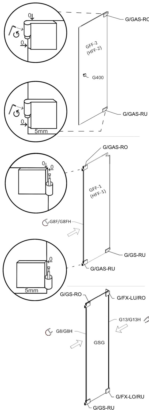
Bei gerader Wand kann auf das Kompensationsprofil G13/G13H verzichtet werden und der senkrechte Wandanschluss wird dann absilikoniert (Abstand Wand / Glas min. 3 mm).
