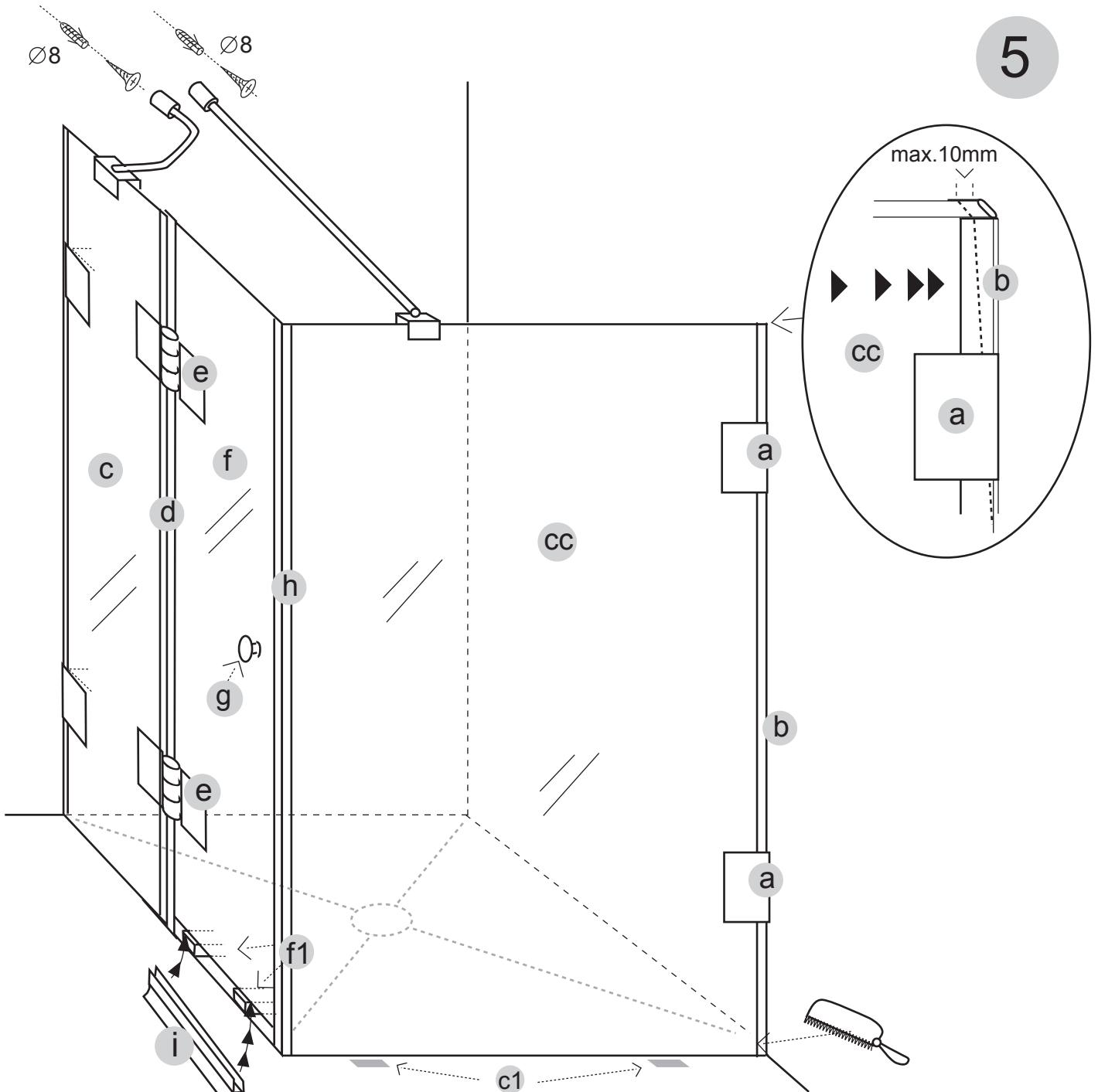
**D** Richten Sie die feste Seitenwand(c) senkrecht aus und schieben Sie das Kompensationsprofil(b) mit Druck an die Wand um Schrägen auszugleichen, kürzen Sie das Sockelprofil(d) so ein, dass es zwischen Kompensationsprofil(b) und Magnetleiste(e) passt. Fixieren Sie dann mit den Wandbefestigungen(a). Bei gerader Wand kann auf das Kompensationsprofil(b) verzichtet werden und der senkrechte Wandanschluss absilikoniert werden (Abstand Wand / Glas min. 2 mm).
